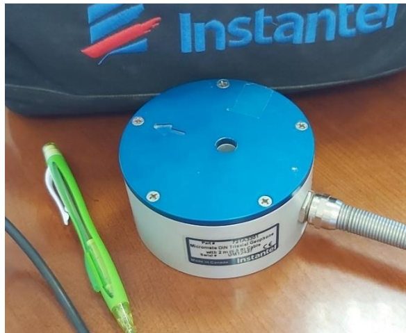
Figura 21 - Geofone triaxial (DIN) utilizado
