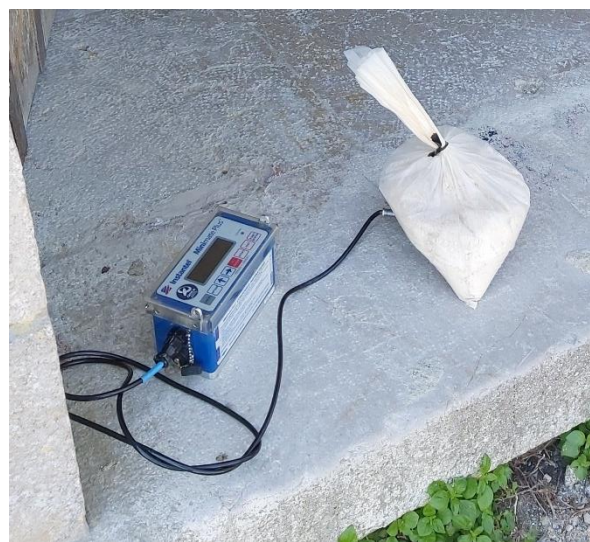
Figura 20 - Instalação do sismógrafo Minimate no Forte Velho do Outão
