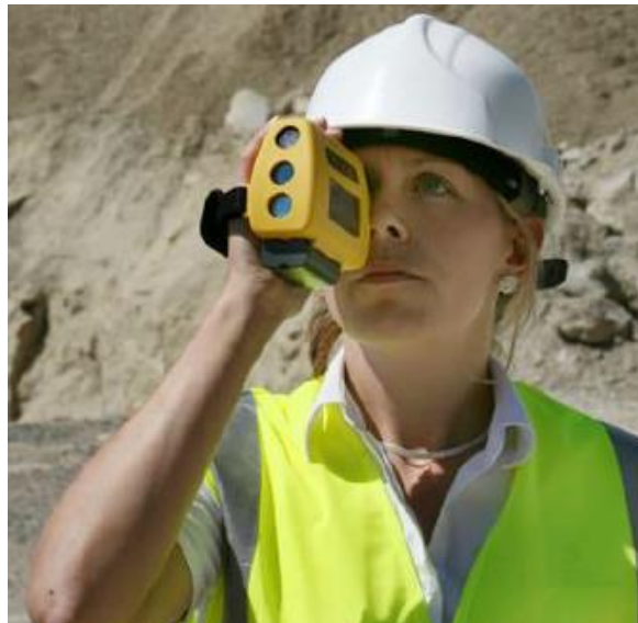
Figura 9 - LaserAce1000 Rangefinder a ser utilizado. (Trimble, 2011).
