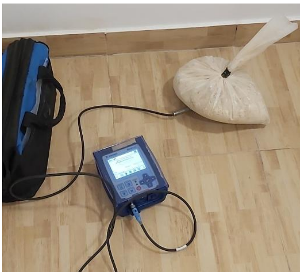
Figura 19 - Instalação do sismógrafo Micromate no escritório da pedreira do Vale do Covão
